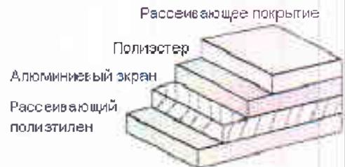
Стенки пакетов выполнены из четырех слоев для обеспечения высокого уровня статического экранирования и механической прочности. При этом пакет прозрачен, что не требует его вскрытия для визуальной инспекции содержимого.
